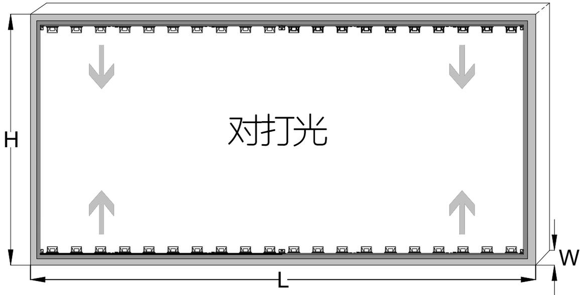
安装示意图说明：测试面板为3mm厚亚克力白板，透光率约为54.4%实验选用铝合金灯箱模型，按照产品光电性能参数均匀排布
