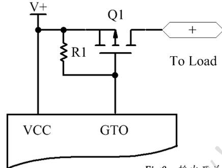
Fig6. 输出开关控制图
