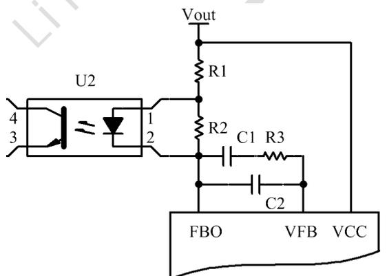
Fig4. 电压环路图
